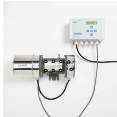
照片：配 100mmPVC 测量流通池的 ColorPlus Bypass
