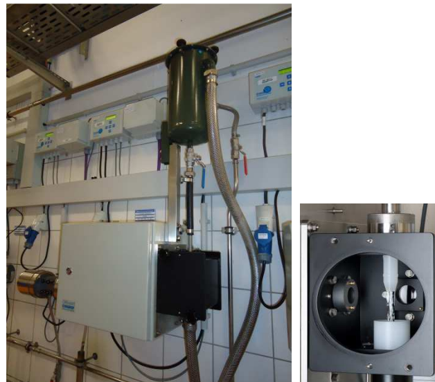
图 2 和图 3: 水中油监测仪 OilGuard，溢流式流通池 PVDF
