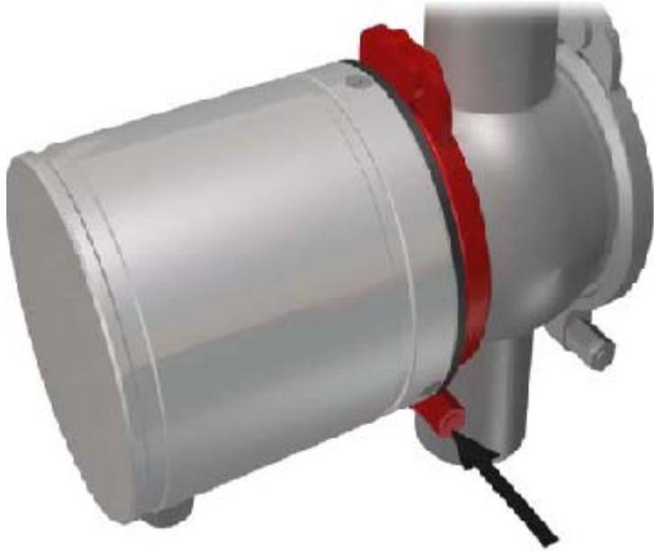
2.2 将光度计从管道上拆下，并取下旧的密封圈换上新的密封圈（箭头所示位置）
