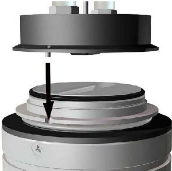
4.2 拧紧固定卡环，将光度计与校准单元固定在一起。
